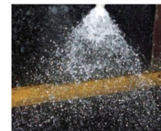
在扰动传质件的上方，气流将液体吹散撕裂为大尺度的液滴，利用重力，液滴落回到传质件上，循环往复。液体在气流中停留时间长，大尺度分散相液滴与气流接触充分，液体与气流反应充分，用于液体输送的能耗大幅度降低。
